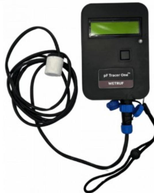
Sonde à plâtre WETRUF® | potentiel hydrique (pF) | dédiée pF Tracer One
